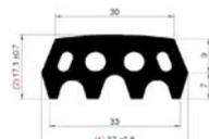
Figure 2 • Joint de voussoir installé à Minsk
