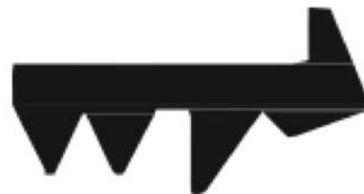
Le joint CONNECTOR, installés sur un réseau d'assainissement se conforme aux directives de la norme NF EN 1917.
