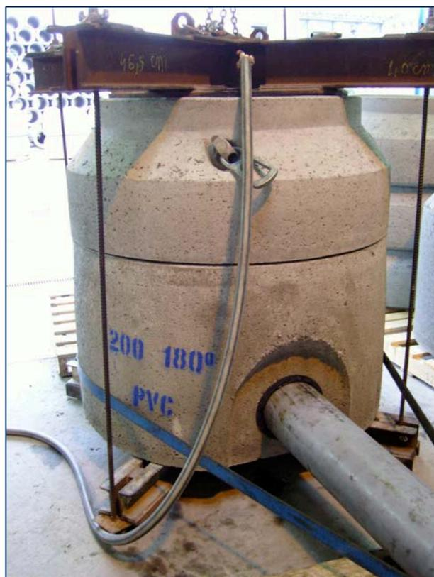
L'élastomère choisi est l'EPDM à structure dense, conforme à la norme EN 681-1, offrant une grande élasticité pour une excellente souplesse d'écrasement à l'emboîtement.
