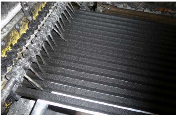
Extrusion en parallèle des cordons butyliques
