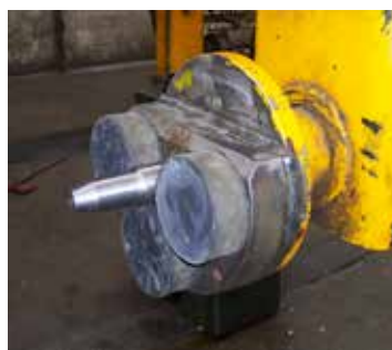
Axe Ø25 de palonnier pour retournement de chambre
