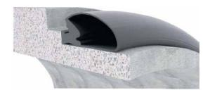
Le joint ANGEL est tendu à l'horizontal sur l'about mâle de l'ouvrage en béton. La lubrification manuelle sur chantier n'est pas nécessaire avant l'emboitement.
