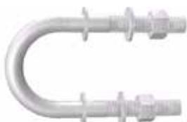
L'anneau de tirage type «Étrier à visser» d'une longueur hors tout de 235 porte la référence ET235. Celui-ci est équipé de deux rondelles soudées à 70 mm et de deux jeux de rondelles et écrous M20. L'entre-axes est de 100 mm.
