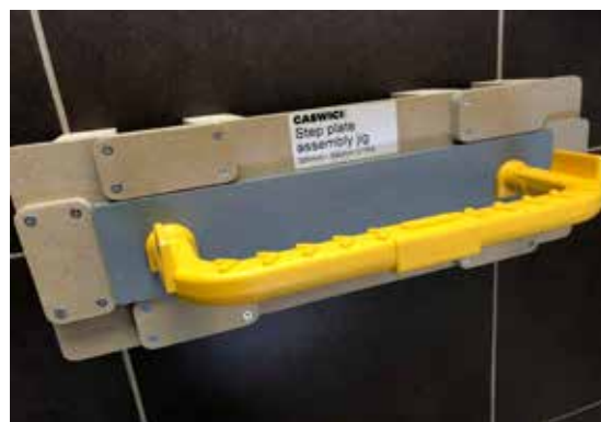
Outil spécial à sertir l'échelon sur la plaque d'obturation
