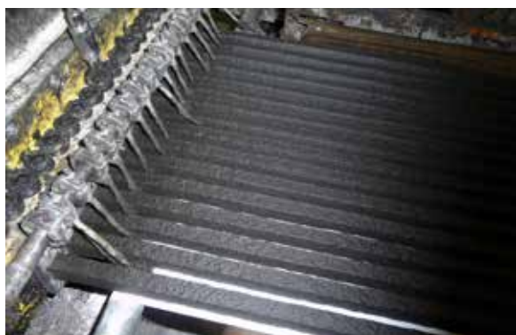
Extrusion en parallèle des cordons butyliques
