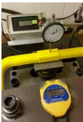
L'échelon de classe 2 doit pouvoir supporter une charge verticale de 2 kN pendant 60 secondes sans déformation supérieure à 10 mm. Une fois la charge retirée, la déformation résiduelle ne peut dépasser 2 mm.
